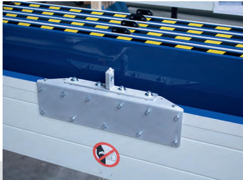
Consola de conexión preparada para puertas con accionamiento neumático
