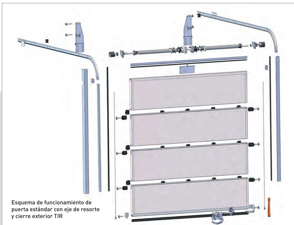
Esquema de funcionamiento de puerta estándar con eje de resorte y cierre exterior TIR
