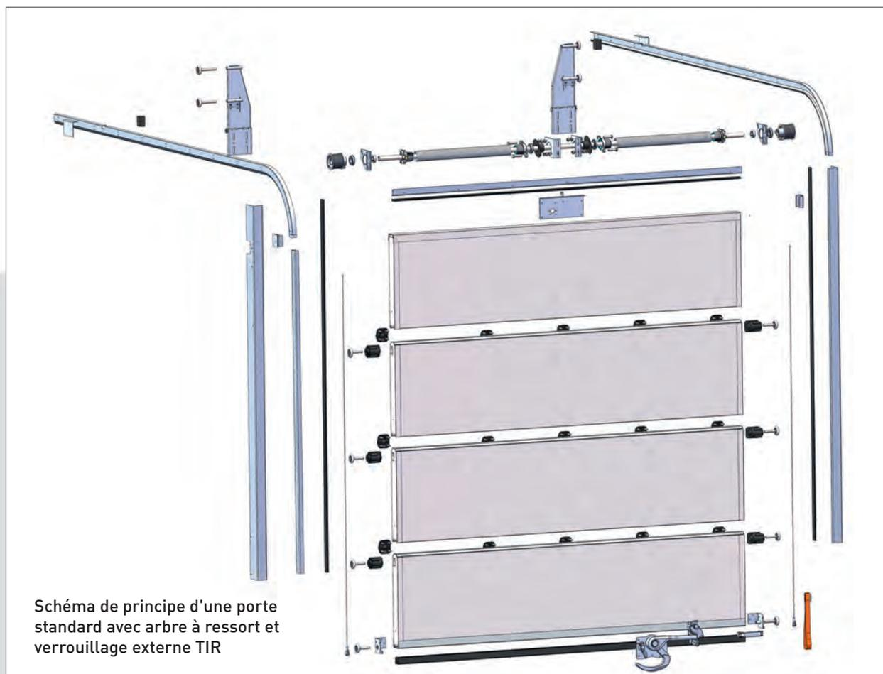
Schéma de principe d'une porte standard avec arbre à ressort et verrouillage externe TIR
