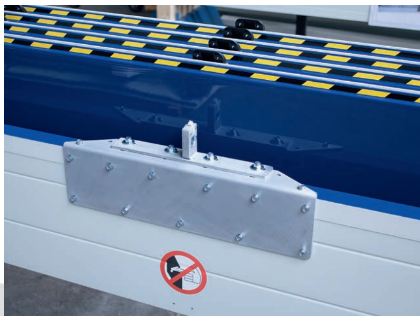
Jungiamoji gembė, parengta vartams su pneumatine pavara
