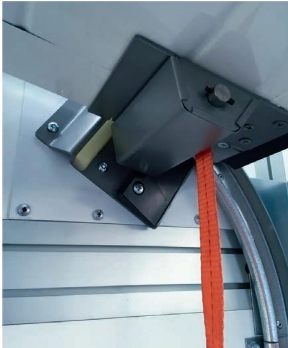
Механический фиксатор, доступен в качестве опции
