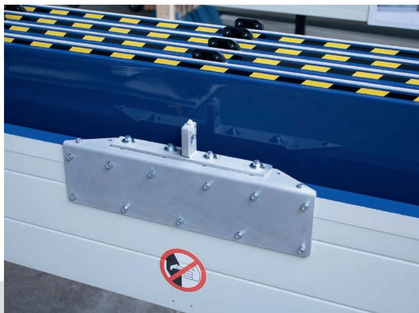
Консоль для примыкания, подготовка для ворот с пневматическим приводом
